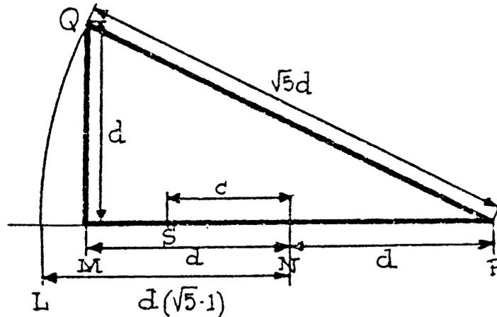
Si d es el segmento MN, lo prolongas otro tanto hasta P, levantas una perpendicular a MP en M y tomas Q tal que MQ = d. Entonces (Pitágoras)  $QP = d \cdot \sqrt{5}$ . Con centro en P trazas el arco QL y así resulta claramente que
