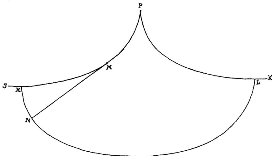
Si cuelgas el péndulo de P con una cuerda de longitud  $4r$  y colocas a ambos lados de P una cicloide PHJ y PLK como topes, según está indicado, entonces
