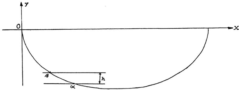
Si se deja caer una bola desde el punto del parámetro  $\beta$ , entonces, según la ley de caída libre, llega al punto de parámetro  $\alpha$  con una velocidad  $\sqrt{2gh} = v_\alpha$ , siendo  $h$  la diferencia de altura entre los dos puntos, es decir
