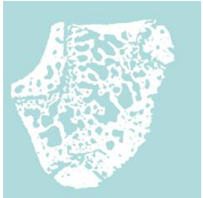
Deze doorsnede van het dijbeen (van een muis) is het resultaat van een discrete tomografie-reconstructie op basis van gegevens uit de scan.
