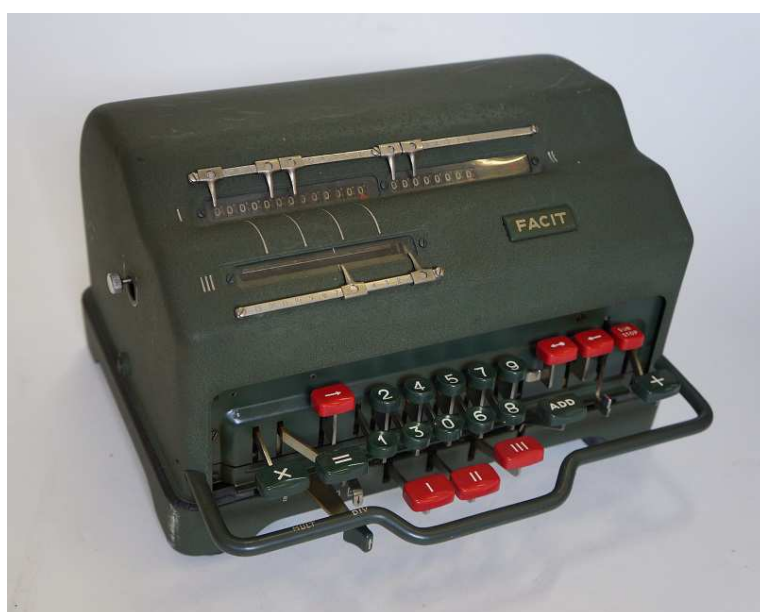
Figura 1: Calculadora eletromecânica FACIT ESA-0, fabricada pela empresa sueca ÅTVIDABERG-FACIT entre 1950 e 1956, pertencente à coleção do Departamento de Matemática da Universidade de Coimbra (282 × 260 × 182 mm, 13 Kg; número de série 372107).
