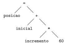
A forma como a árvore é construída é determinada por um conjunto de regras (diagramas de sintaxe do  $C, \ldots$ ).
