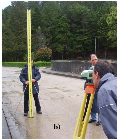
Figura 3.6 – a) Nível. b) Observações de uma linha de nivelamento geométrico utilizando um nível e respectiva mira.
