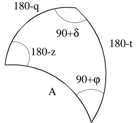
figura A-3 - Triângulo polar do triângulo de posição
