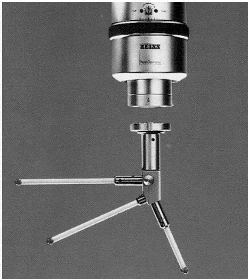
figura 1-4 - Ponto de referência na cabeça de palpação e conjunto de palpadores (ZEISS) [19]
