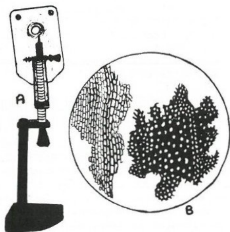
Fig. 1 - Esquema do microscópio de Leeuwenhoek (A): o objecto era colocado na ponta da agulha e regulável em altura e distância; (B): o primeiro desenho do tecido vegetal (cortiça), mostrando a estrutura celular, por Robert Hooke.
